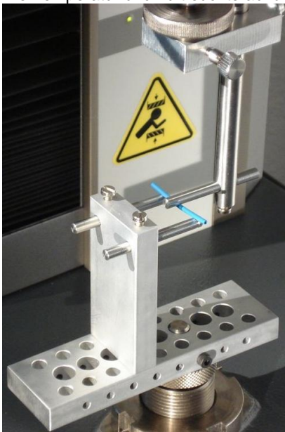
Abbildung 1: Rohrprobe aus Kunststoff während der E-Modul Messung
